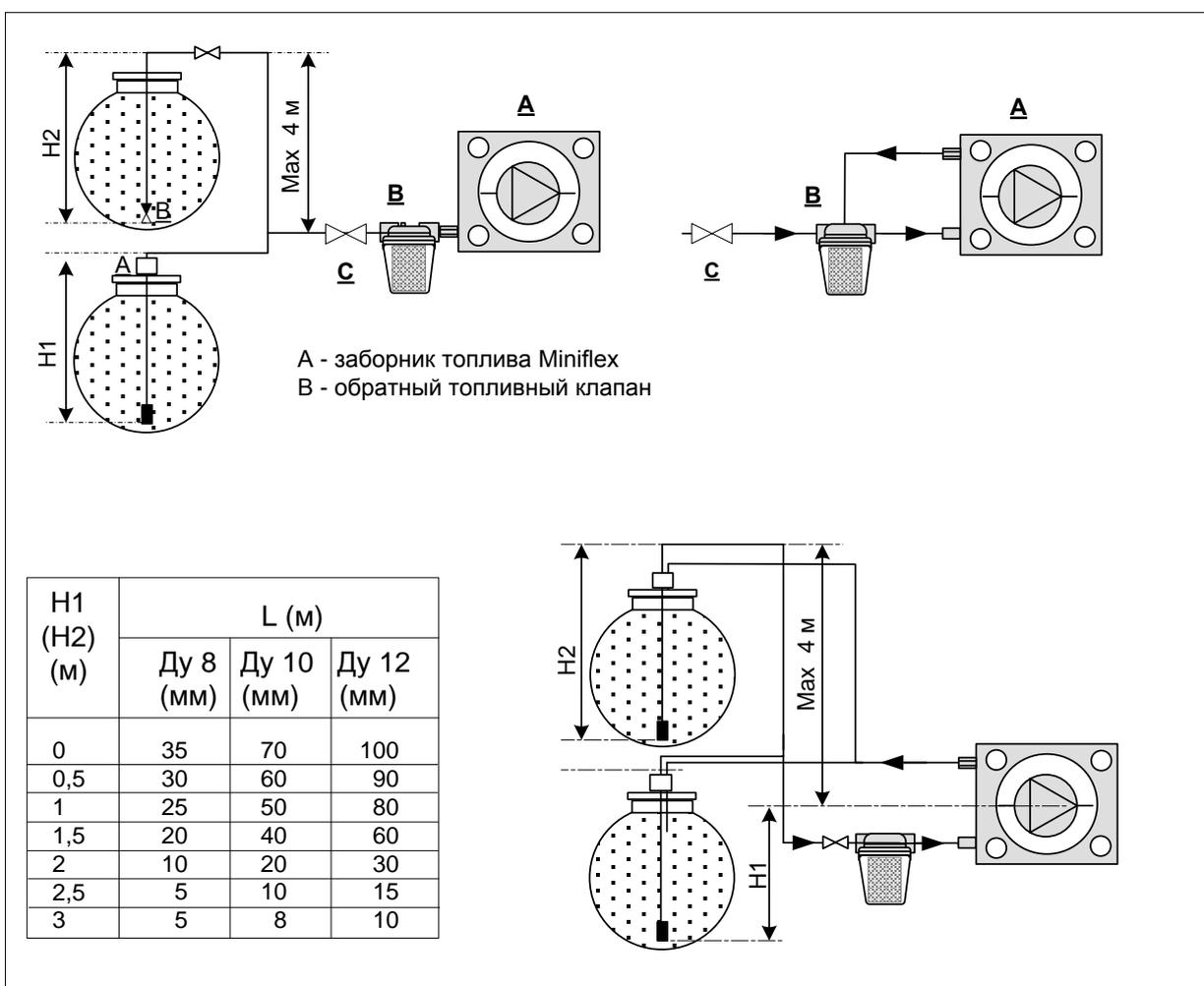
**ВНИМАНИЕ!** Уклон и поворот топливопровода, а также каждый дополнительно установленный фитинг и запорный вентиль, сокращают общую протяженность топливной магистрали.
